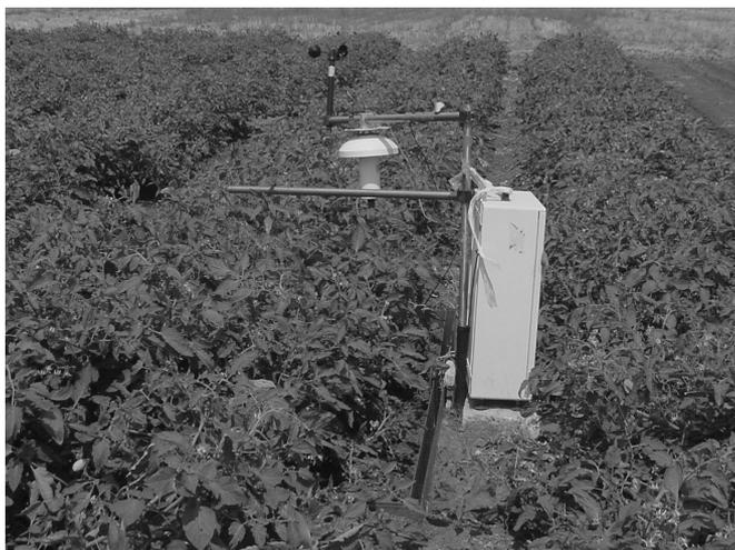
Fig. 6 - Stazione lisimetrica per la misura diretta dei consumi idrici delle colture in Agro di Gaudio di Lavello (pomodoro, estate 2002)
